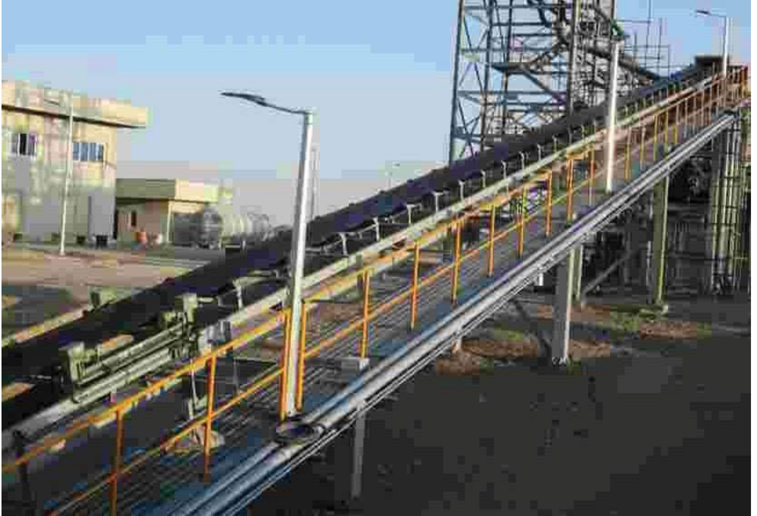
ساخت انواع تجهیزات جانبی مربوط به نوار نقاله و نصب و راه اندازی نوار نقاله واحد کنستانتیره سنگ آهن معدن اسمالون یزد
